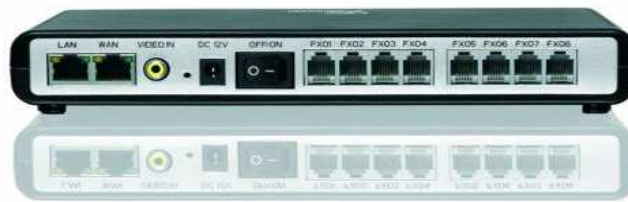
Figura 1-14. Adaptador analógico para interconexión con la RTC, marca Grandstream. Dispone de 8 puertos FXO y dos puertos RJ45 (incorpora router)
