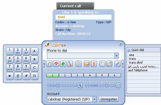
Figura 1-16. Softphone Zoiper, puede trabajar con el protocolo SIP o IAX, y dispone de una versión gratuita y otra comercial
