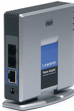
Figura 1-13. Adaptador telefónico para analógico y SIP (Linksys PAP2). Obsérvese que dispone de 2 puertos analógicos (puertos FXS) para conectar dos teléfonos y un puerto RJ-45 para conectividad ethernet.
