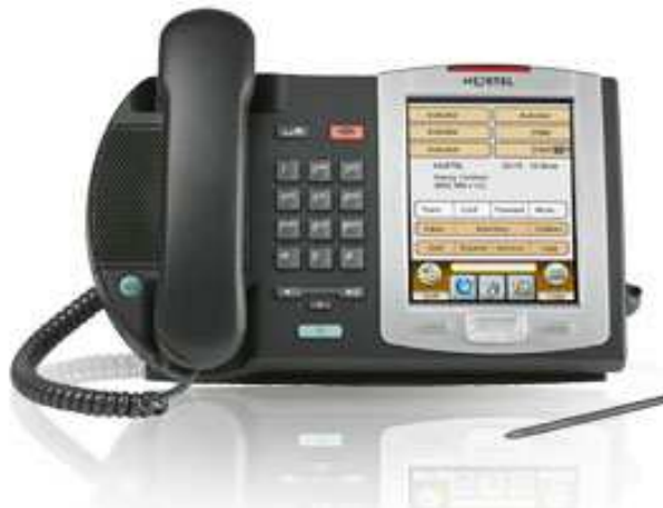
Figura 1-12. Teléfono IP Nortel IP Phone 2007, uno de los últimos modelos de este fabricante en salir al mercado, que incluye entre otras muchas cosas conectividad USB para ratón y teclado, puerto RJ-8 para conectar altavoces y pantalla táctil de 5,7”
